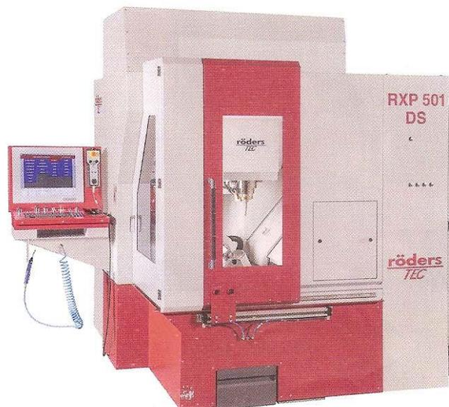
**Das 5-Achs-Bearbeitungszentrum Rödgers RXP 501 DS** wurde für höchste Genauigkeitsanforderungen bei zugleich hohen Zerspantungleistungen bei der Bearbeitung harter Werkstoffe ausgelegt © Rödgers
